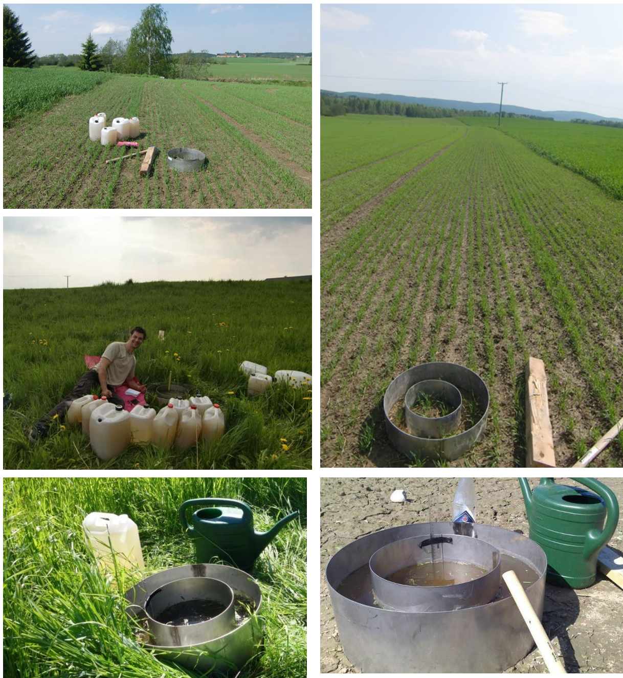
Figur 8. Bildene er fra feltforsøkene og viser bl.a. dobbelt-ring infiltrometer.
